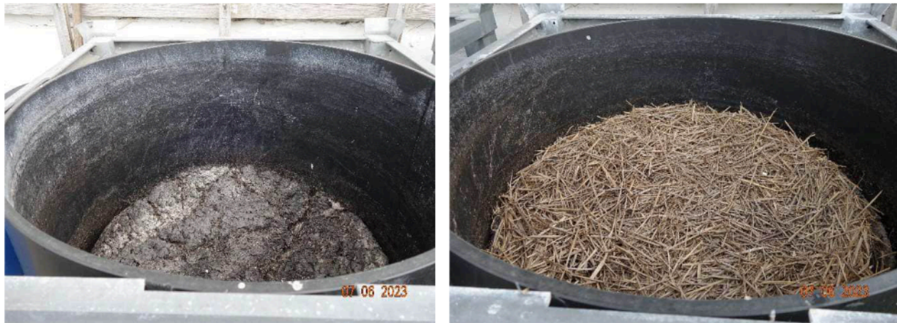
Abbildung 4.4.3: Entwässerungsbehälter a) links, ohne Zuschläge und b) rechts, mit Zuschlägen
